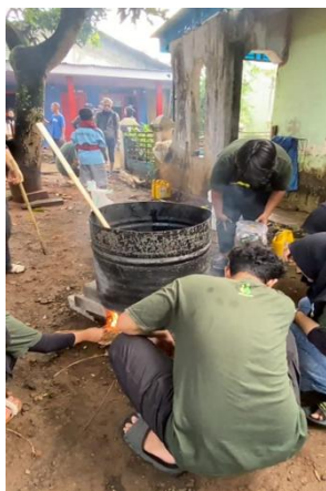
Gambar 2. Memanaskan Drum lalu menuang 1600 ml oli ke dalamnya
