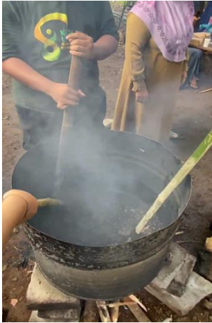
Gambar 6. Masukkan Pasir dan Semen ke dalam cairan oli dan aduk hingga mengental dan olesi cetakan dengan oli.
