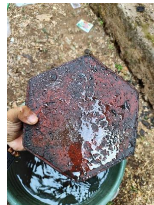
Gambar 9. Keluarkan dari cetakannya dan rendam dalam air dalam beberapa waktu agar paving lebih kuat.
