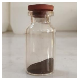
Gambar 4. Hasil Sintesis Nanomagnetit Fe 3 O 4
