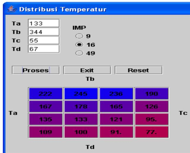
Gambar 5 Tampilan distribusi temperatur untuk 16 titik
