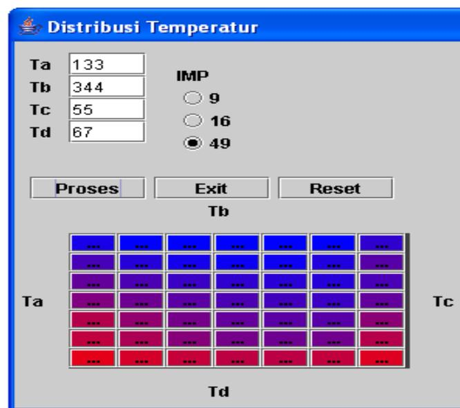
Gambar 6 Tampilan distribusi temperatur untuk 49 titik
