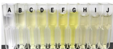
Gambar 1. Uji Flavonoid Dengan Beberapa Konsentrasi Keterangan : A : Blanko; B, C, D, E, F, G : Standart Quarsetin 20 µg/mL, 30 µg/mL, 40 µg/mL, 50 µg/mL, 60 µg/mL, 70 µg/mL; H, I, J : Sampel
