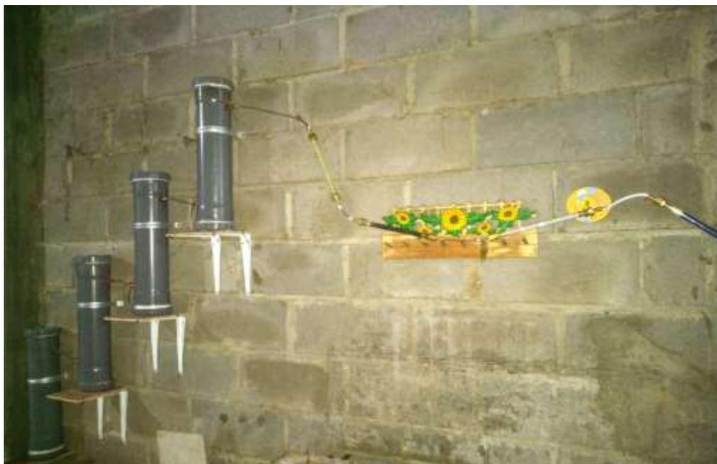
**Gambar 3.** Instalasi Pemurnian biogas berbasis kolom adsorben padat yang dilengkapi indikator kejenuhan adsorben
