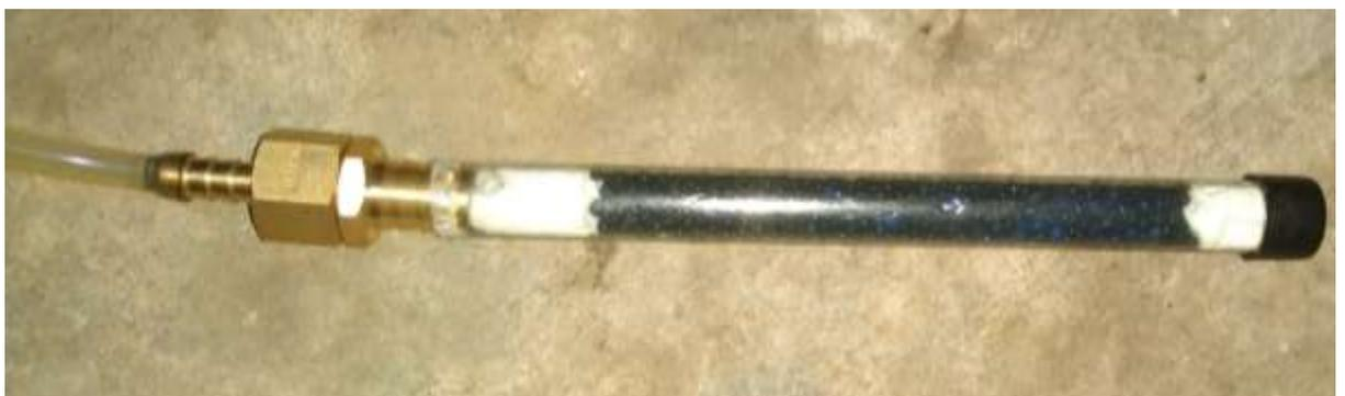
**Gambar 6.** Perubahan warna silica gel menjadi hitam ketika biogas tanpa pemurnian dilewatkan melalui kolom indikator silica gel.
